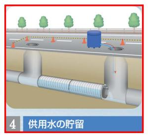
充填工における浮上防止のための支保工は無し。 供用水を貯め、抗浮力とするため、既設管内に 作業員が入らない安全な充填工を実現。 (他工法では重量物を管内に引き入れたり、新管 に穴をあけ支保工設置を行う)
