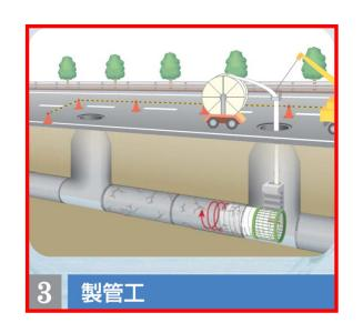
製管はマンホールから行う元押し方式、既設管内に作業員が入らない、安全な製管工程を実現。 (小口径では他工法にも元押し方式有るが、中大口径はSWライナーのみ)
